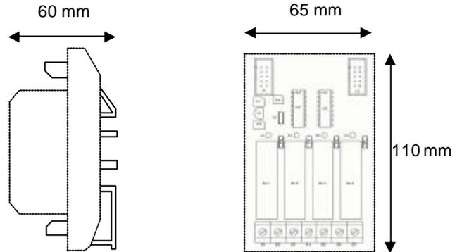
Le module d'extension ME/RS4 permet d'ajouter 4 sorties "PUISSANCE" à un module MTES, MTCA ou UTiL/Tillys (sur le bus local UTiL/Tillys uniquement)
